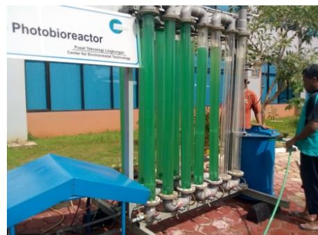
Gambar 4. Proses pengisian kolom – kolom reaktor dengan sistem pompa
